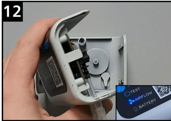
**Fase 12.** Rimuovere le due viti sul retro del monitor F Essential. Rimuovere quindi il coperchio posteriore, inserire le batterie e si verificherà un doppio lampo bianco sulle spie del flusso d'aria e della batteria. La spia del flusso d'aria anteriore lampeggerà poi con una luce blu. Controllare che i tubi siano collegati all'interno del monitor.
