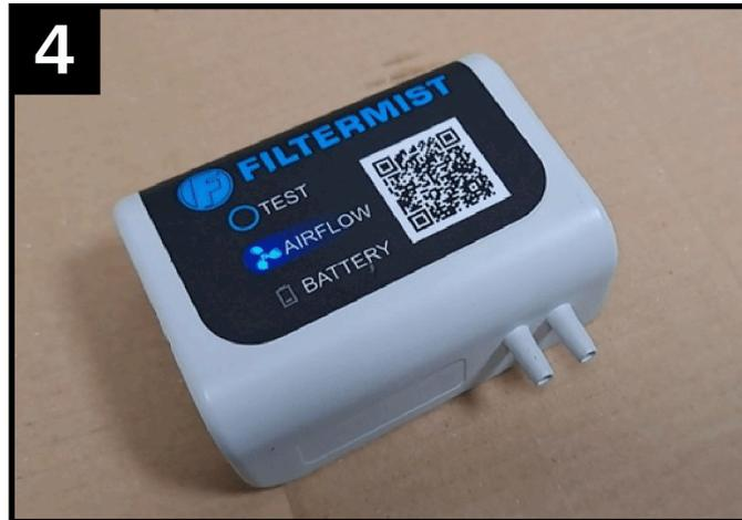
**Fase 4.** All'avvio, le spie del flusso d'aria e della batteria lampeggiano due volte. Successivamente, la spia del flusso d'aria lampeggia continuamente in blu. Ciò indica che l'unità non è calibrata.
