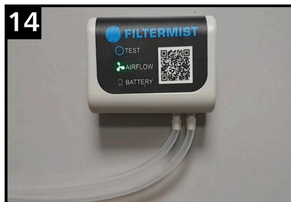
**Fase 14.** Rimontare il coperchio posteriore. Dopo due minuti la luce verde tornerà a lampeggiare e si accenderà ogni 10 minuti.
