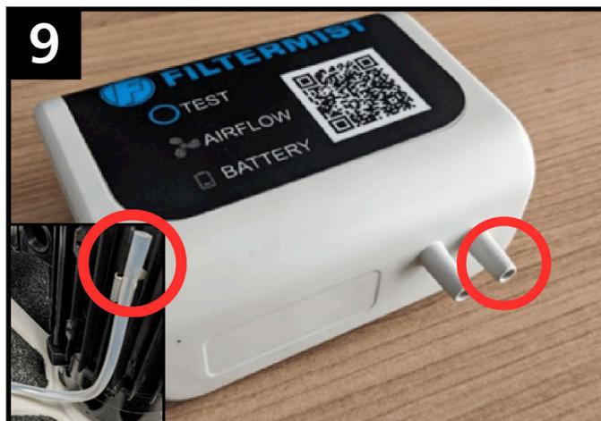
**Fase 9.** Collegare l'altro tubo al motore utilizzando la clip del motore con il tubo rivolto verso l'alto. Quindi fissarlo all'ugello destro sul fondo del monitor.
