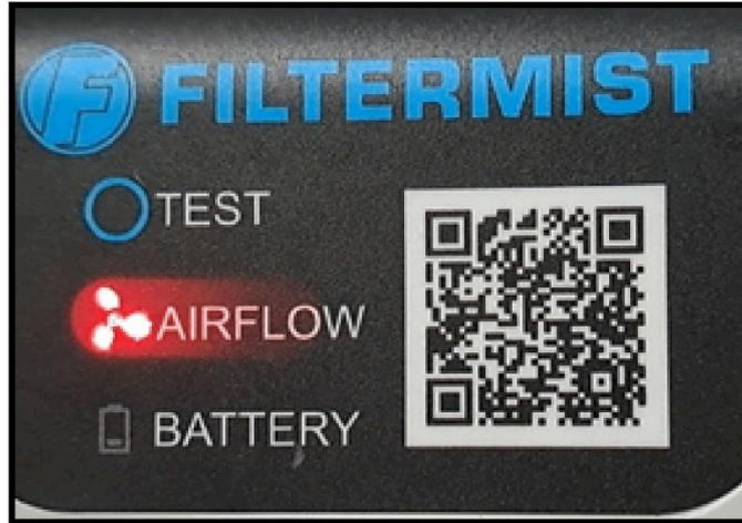
In caso di luce ROSSA, verificare la presenza di un'ostruzione prima di chiamare l'assistenza. Seguire le procedure indicate di seguito.
