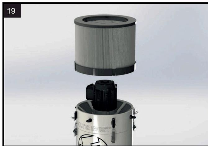
**Fase 4.** Assicurarsi che il post-filtro non sia ostruito, rimuovendolo dall'unità di filtraggio e controllando.
