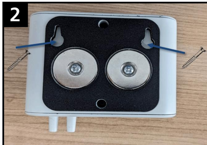
**Fase 2.** In alternativa, fissare due viti a 60 mm di distanza su una superficie verticale piana e agganciare il monitor alle viti. Diametro massimo della filettatura 3,5 mm, diametro massimo della testa 8,5 mm.
