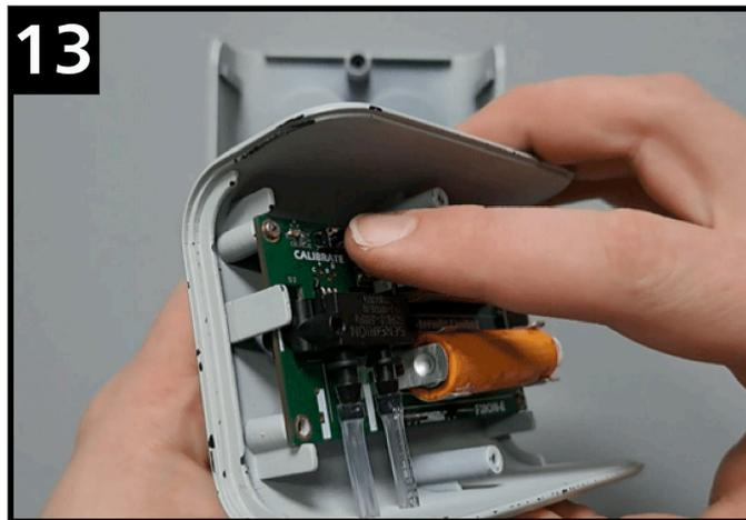
**Fase 13.** Quando i tubi sono collegati e l'unità è accesa e ruota nella direzione corretta, premere il pulsante di calibrazione sulla scheda di circuito. Il monitor si calibrerà per i primi 10 secondi e una luce verde fissa rimarrà accesa per due minuti mentre il flusso d'aria viene rilevato dinamicamente (se lampeggia una luce blu, è possibile che i tubi siano stati collegati nel modo sbagliato).
