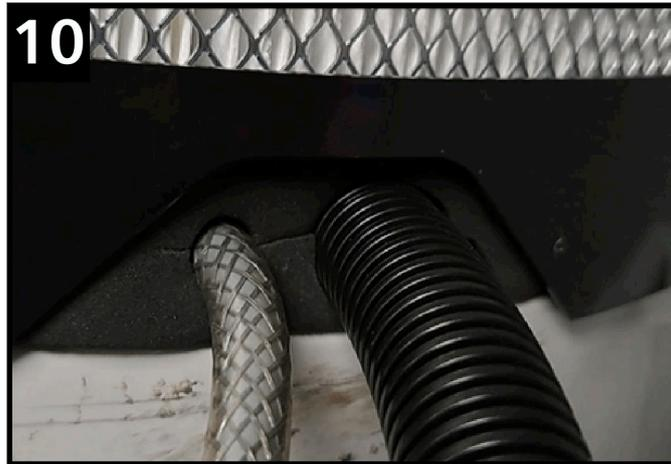
**Fase 10.** Far passare il condotto attraverso la guarnizione del post-filtro (se il post-filtro è presente) e fissare il post-filtro in posizione utilizzando le clip.
